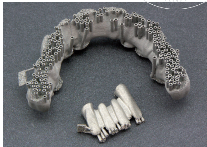
Fig. 17 Armatures à réception avec leurs supports de fabrication.
